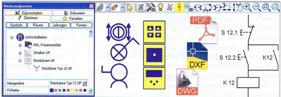
Die Funktion «Bauherrenansicht ein/aus» ermöglicht bei Hemag-CAD einen Wechsel zu einer für die Bauherrschaft verständlicheren Ansicht eines Elektroplans.
